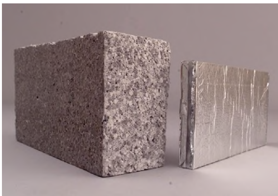
Abbildung 1: Links – Expandiertes Polystyrol (EPS) und VIP gleicher Wärmedämmwirkung. Rechts – Wärmeleitfähigkeit verschiedener Wärmedämmstoffe im Vergleich. Bilder: FHNW
